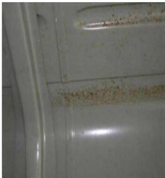
Рисунок 50 – Дефекты, приведшие к разрушению ЛКП:
