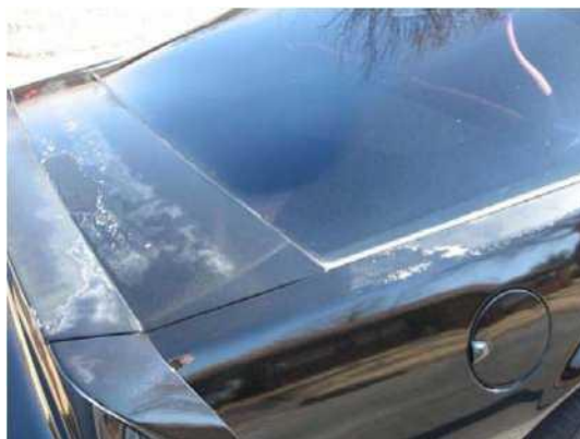
Рисунок 49 – Расслоение лакокрасочного покрытия
