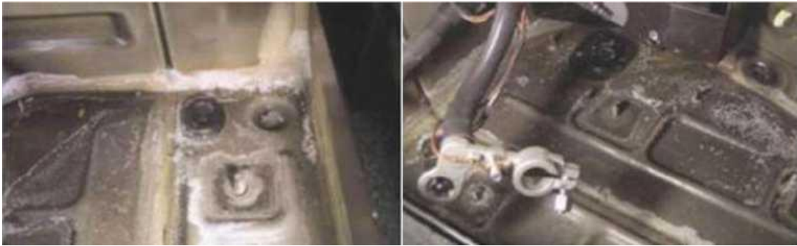
Рисунок 40 – Пятна от электролита на ЛКП
