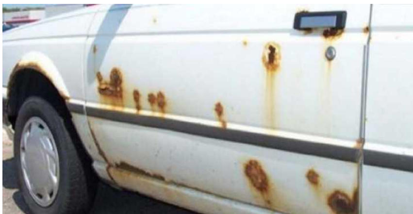
Рисунок 51 – Коррозионное разрушение ЛКП
