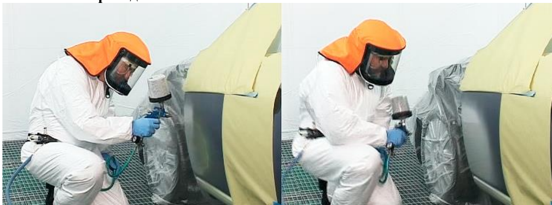
Рисунок 3 – Нанесение акрилового грунта-наполнителя. После его высыхания и шлифовки деталь можно красить
