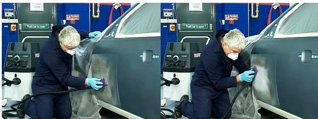
Рисунок – Шлифуем поверхность ручным шлифком и абразивной полоской Р320. Шлифовать следует диагональными движениями, чтобы неровности «срезались» равномерно по всей плоскости.
