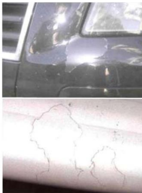
Рисунок 50 – Дефекты, приведшие к разрушению ЛКП:
