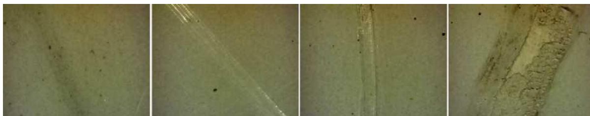
Рисунок 22 – Следы от грифеля карандаша в процессе определения твердости по методу Вольфа Вильборна
